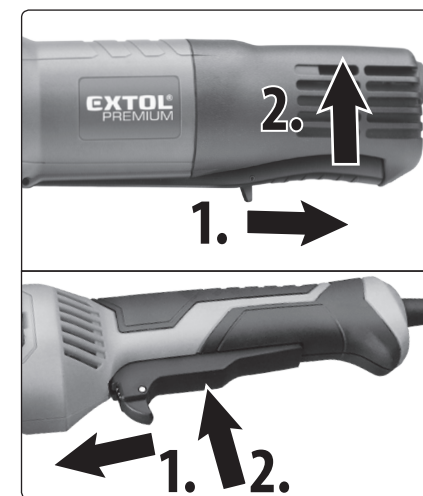
Obr. 15; krok 1. odistenie, krok 2. zapnutie
