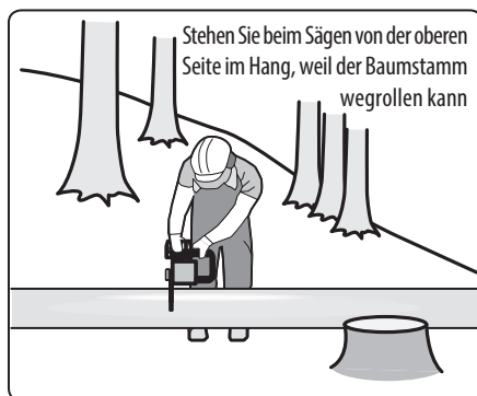
Querschneiden/-ablängen von Stämmen, Abb. 16
